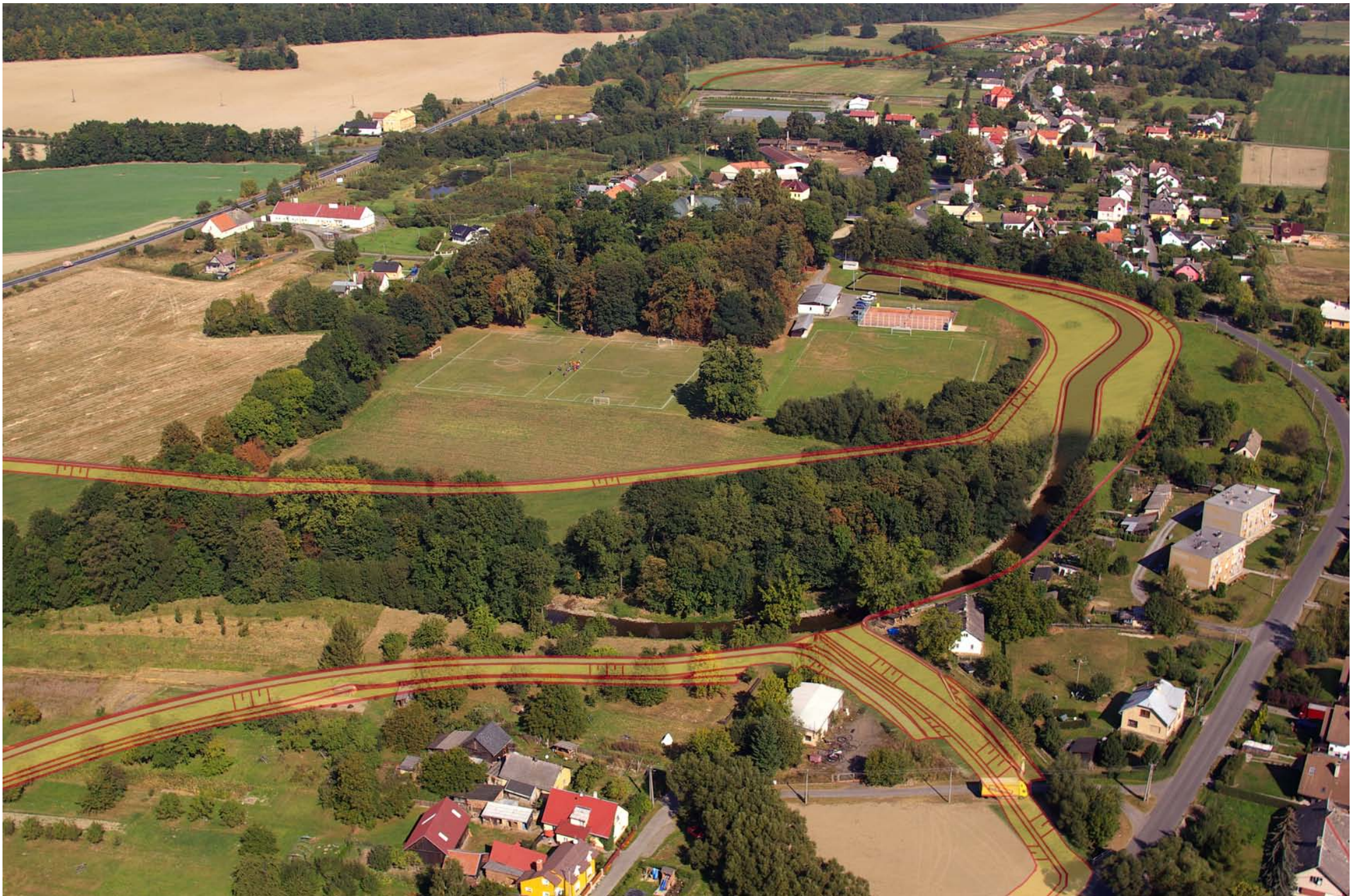
Obec Brantice, letecký pohled po vodě na úsek nad jezem v km 78,340 - po realizaci navržených opatření (zvýrazněné kontury navrhovaných konstrukcí)
